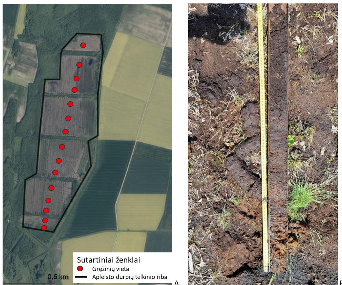
3 pav. Durpių klodo tyrimai apleistame Laukagalio durpių karjere (Kėdainių r.): A – gręžinių lokalizacijos schema, B – geologiniu grąžtu paimto durpių klodo mėginio pavyzdys.
