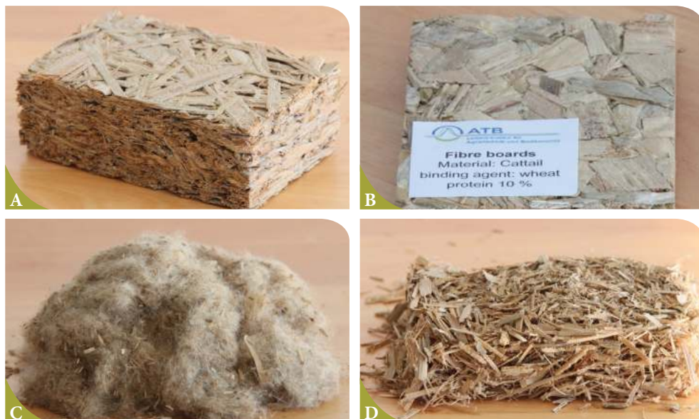
31 pav. Iš švendrų biomasės pagamintos statybinės medžiagos: A – švendrų plokštė (gamintojai „Typha Technik Naturbaustoffe“, Fraunhoferio medienos tyrimų institutas (Vilhelmo Klaudico institutas, WKI) Vokietija), B – švendrų plaušo plokštė (gamintojas Leibnico agrotechnologijų ir bioekonomikos institutas, Vokietija), C – švendrų burbulių vata – izoliacinis užpildas (gamintojai „Hanffaser Uckermark“ ir „Wetlands Products“, Vokietija), D – švendrų pjuvenos – izoliacinis užpildas (gamintojai „Hanffaser Uckermark“ ir „Wetlands Products“, Vokietija). © Žydrūnas Sinkevičius
