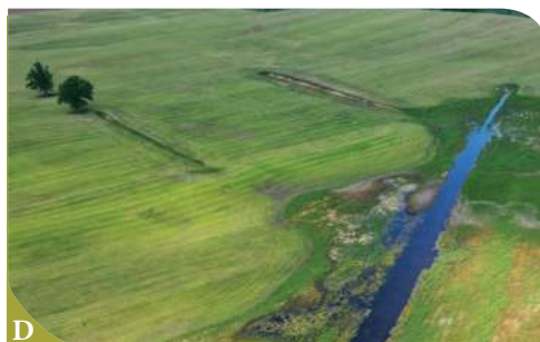
40 pav. Drenažo sistemos pertvarkymas atkuriamame durpyne ir jo aplinkoje, Baisogalos apylinkės, Lietuva, 2022 m.: A–B – šliuzo reguliatoriaus su vienuolio tipo vandens pralaida įrengimas (© UAB Baisogalos statyba, Jūratė Sendžikaitė), C – išvalytas ir performuotas sausinimo griovys (© Jūratė Sendžikaitė), D – pertvarkyti ir į paviršių išvesti drenažo rinktuvai (kairėje) ir patvenktas sausinimo griovys (dešinėje). © Nerijus Zableckis
