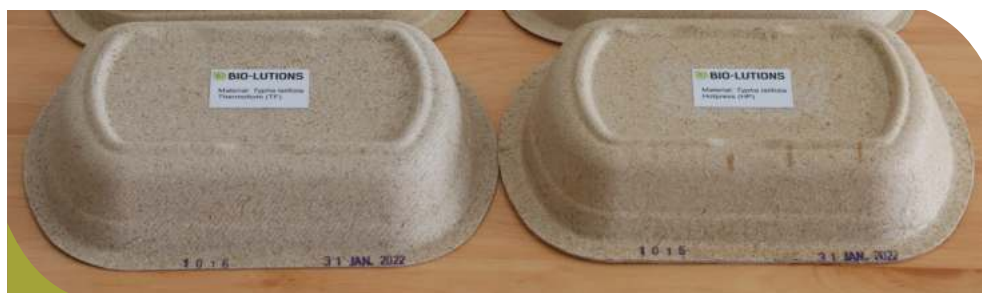
32 pav. Iš plačialapių švendrų biomasės pagaminti vienkartiniai indai (medžiaga – fibcro® natūralus puoštas) taikant dviejų tipų gamybos procesus: A – termoformavimą (TF), B – karštą spaudimą (HP). Gamintojas „BIO-LUTIONS International JSC“, Vokietija. © Žydrūnas Sinkevičius
