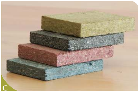
19 pav. Viksvynų ir šlapių pievų biomasės panaudojimas: A – žolės granulės (gamintojas „Nine voices“, Lietuva), B – žolės celiuliozės pluoštas (gamintojas „Gramitherm“, Šveicarija), C – kietojo plaušo plokštė „Paludi Panel“ ir D – kietojo plaušo plokštė „Paludi Sandwich Panel“ (gamintojas „ZELFO® Technology LLC“, Vokietija). © Žydrūnas Sinkevičius
